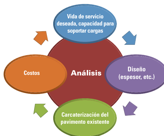
Figura 46. Factores de diseño de la capa de refuerzo que se interrelacionan
