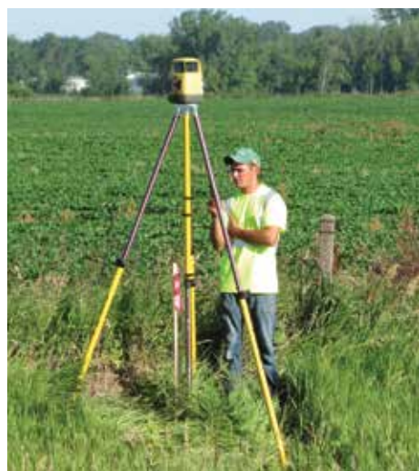
Figura 139. Laser rotatorio sobre un punto de referencia
