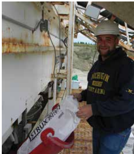
Figura 124. Adición de fibras en la planta (izquierda) y con bolsas vaciadas dentro de un camión betonera (derecha) (fuente: Randell Riley, Illinois Chapter, ACPA)
