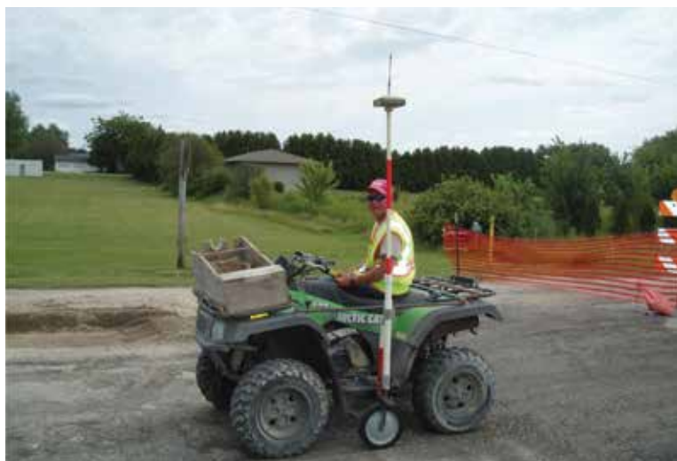
Figura 135. Vehículo todo terreno con GPS y perfilómetro laser
