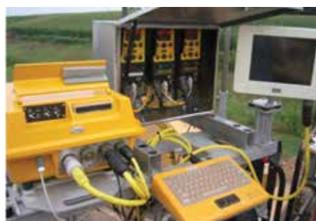
Figura 143. Sistema de control GPS de una pavimentadora
