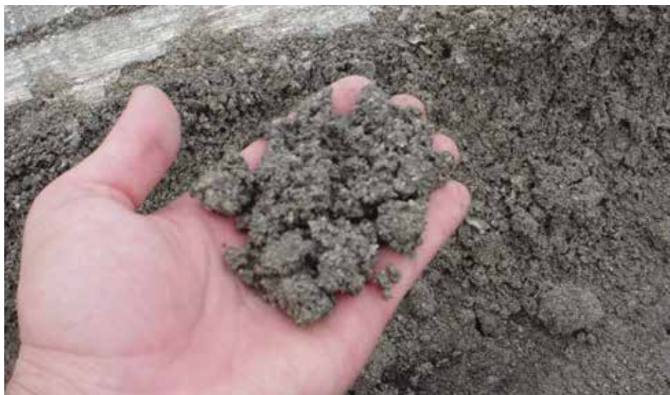
Figura 120. Material de fresado típico de un pavimento de hormigón proveniente de una operación de fresado (fuente: Dan DeGraaf, Michigan Concrete Paving Association)
