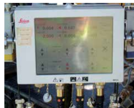
Figura 138. Controles por computación en una pavimentadora
