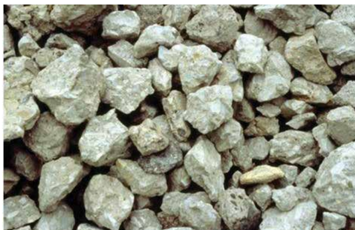
Figura 121. Agregado de hormigón reciclado (fuente: Jonathan Gene Pitre, University of New Hampshire)
