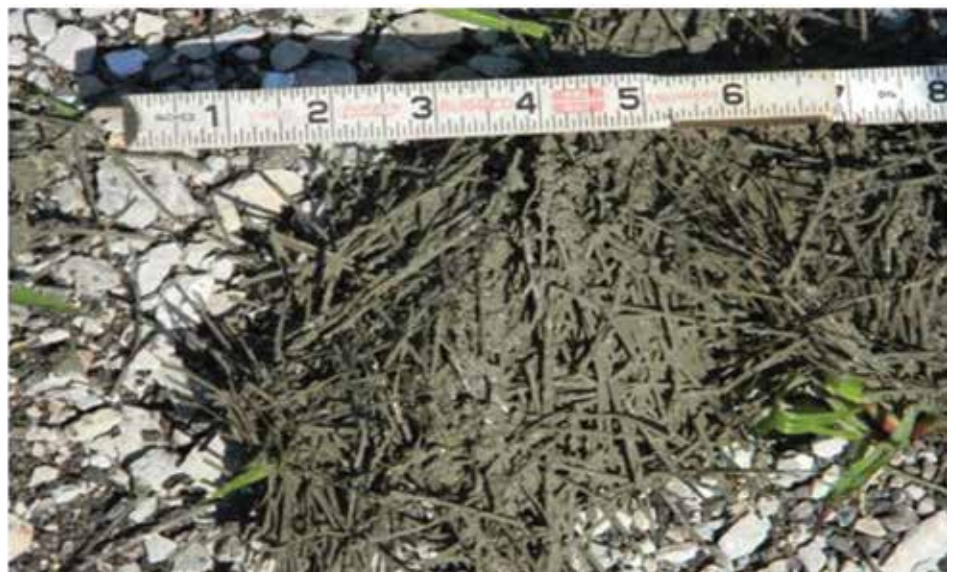
Figura 91. Fibras sintéticas 38,1 mm (1,5 in.) a 57,25 mm (2,25 in.)
