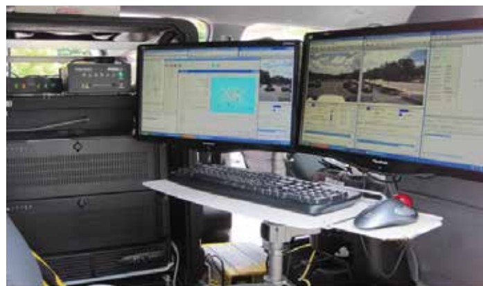
Figura 132. Área a bordo de control de calidad de la operación de un escáner móvil
