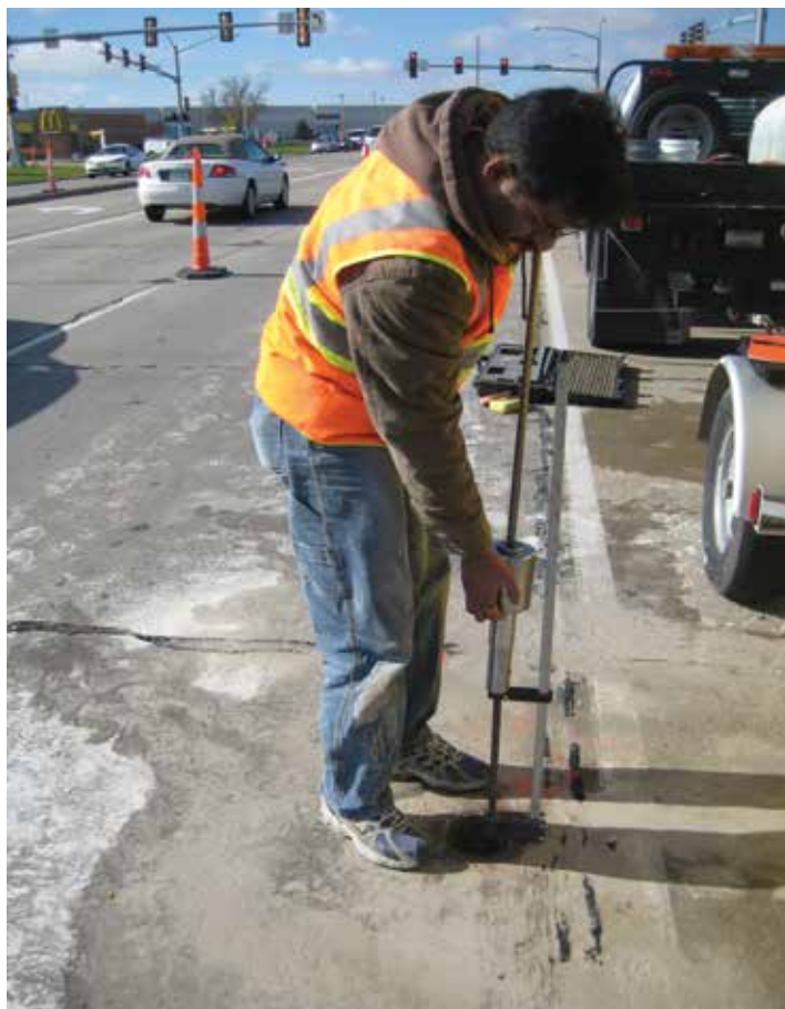
Figura 13. Cono de penetración dinámica (fuente: David White, Iowa State University)
