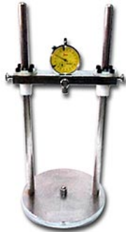
(d) Drying shrinkage and moisture movement apparatus (Intec)
