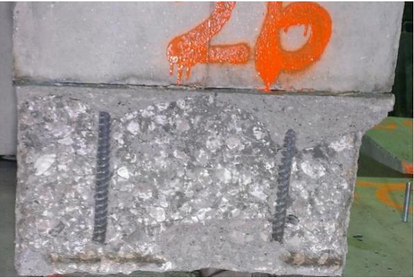
c) Bond interface (substrate concrete)
