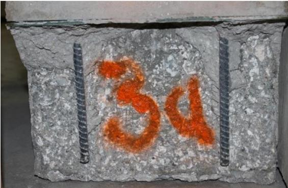
c) Bond interface (substrate concrete)
