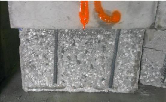
b) Bond interface (substrate concrete)
